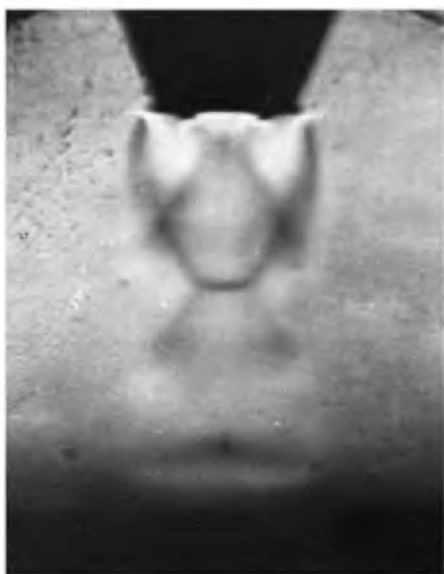
Рис.2 Структура ударных волн с изменением расстояния сопла от преграды.
